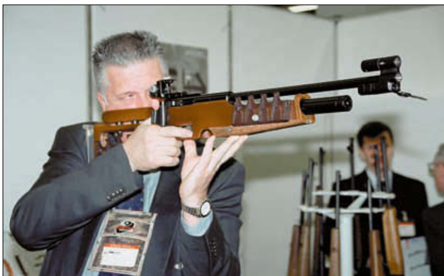
Пневматическая РСР винтовка для биатлона внешне мало чем отличается от огнестрельного образца Би-7-2
