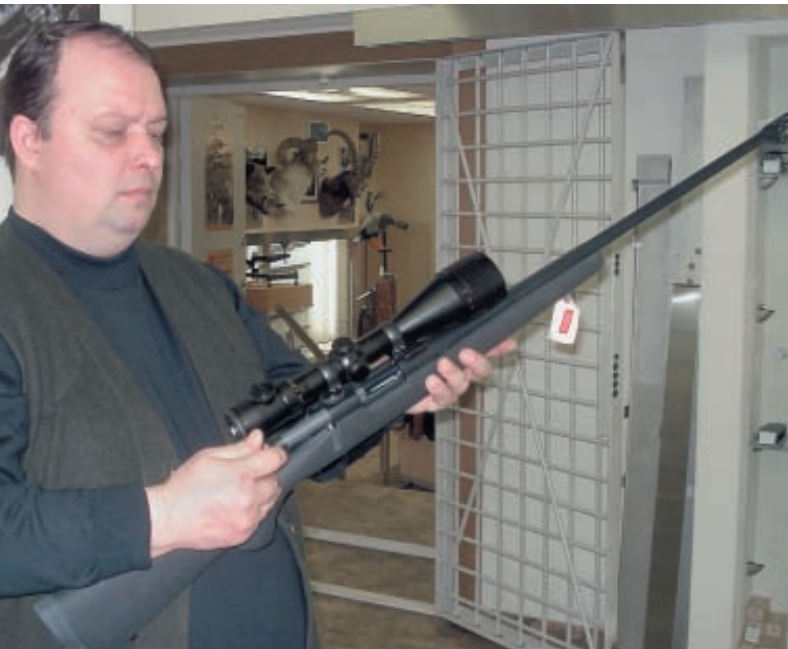
Леонид Безус демонстрирует карабин Carbon Custom фирмы Cristensen Arms. Отличительная особенность этой модели – карбоновые ствол и ложа
