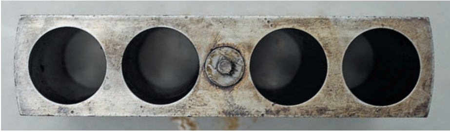
В барабане могли размещаться четыре патрона 4-го калибра
