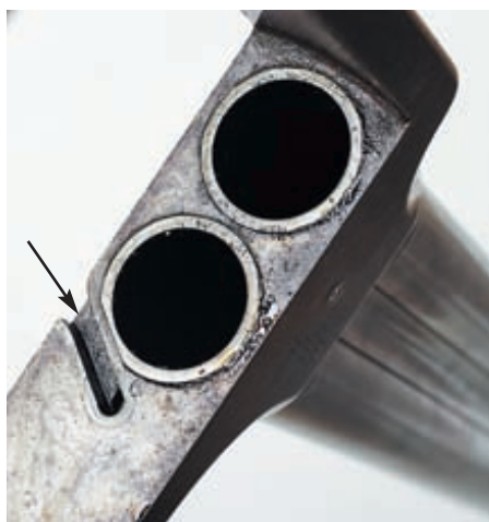
Казённая часть блока стволов. Стрелкой показан паз для оси барабана
