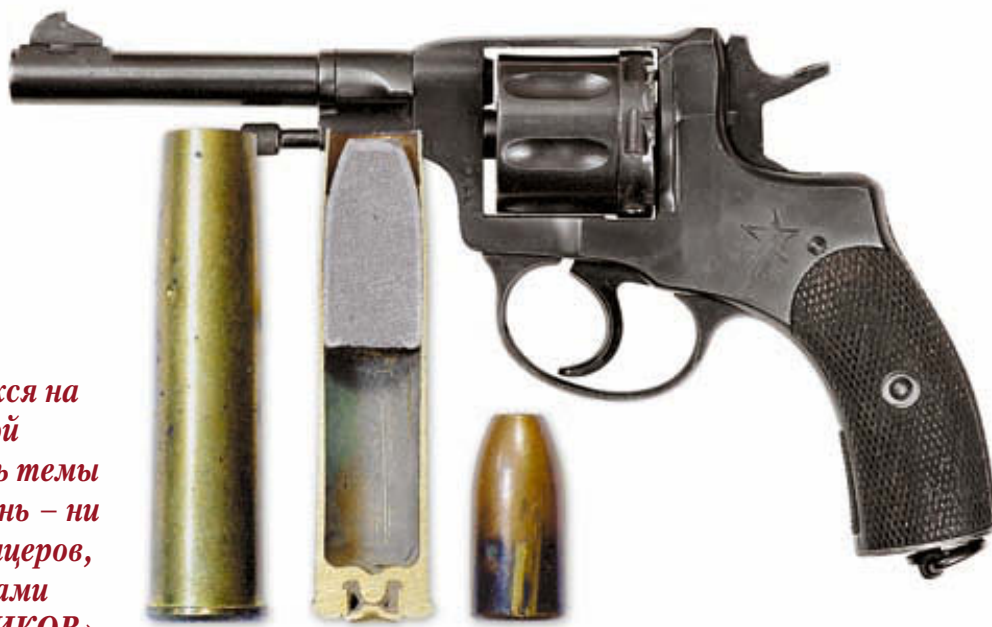
7,62-мм револьверный патрон, его продольный разрез (пороховой заряд удалён) и внешний вид пули с характерной плоской вершинкой
