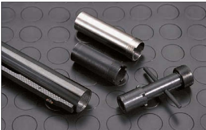
*По сравнению с обычными дульными насадками, сменные чоки, которыми комплектуется Raffaello Crio (вверху) отличаются увеличенной длиной и профилем внутренней поверхности*
