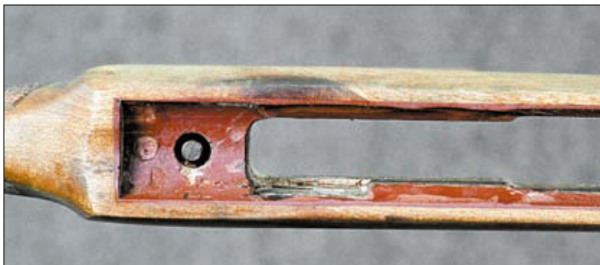
Каждая ложа подгоняется к ствольной коробке индивидуально. На снимке вы видите результаты доводки «постели» после черновой обработки
