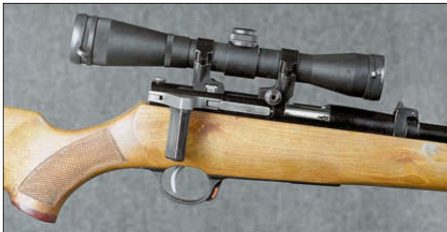
Как ни странно, эти кольца не годятся для установки оптики даже на «мелкашку». Вследствие недостатков конструкции, они не обеспечивают надёжного крепления прицела
