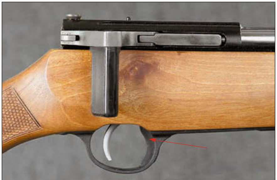
Выключение предохранителя (показан стрелкой) производится указательным пальцем изнутри спусковой скобы. В выключенном положении («огонь») становится видна красная марка (см. подзаголовочное фото)
