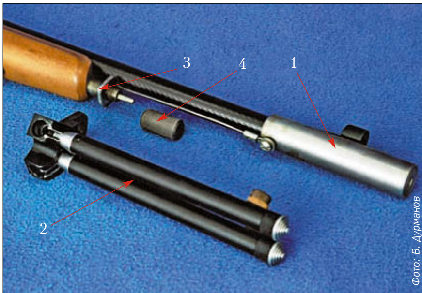
1 – Дульная накладка для чистки ствола, 2 – телескопические сошки, 3 – пенал с эрзац-шомполом, 4 – крышка пенала
