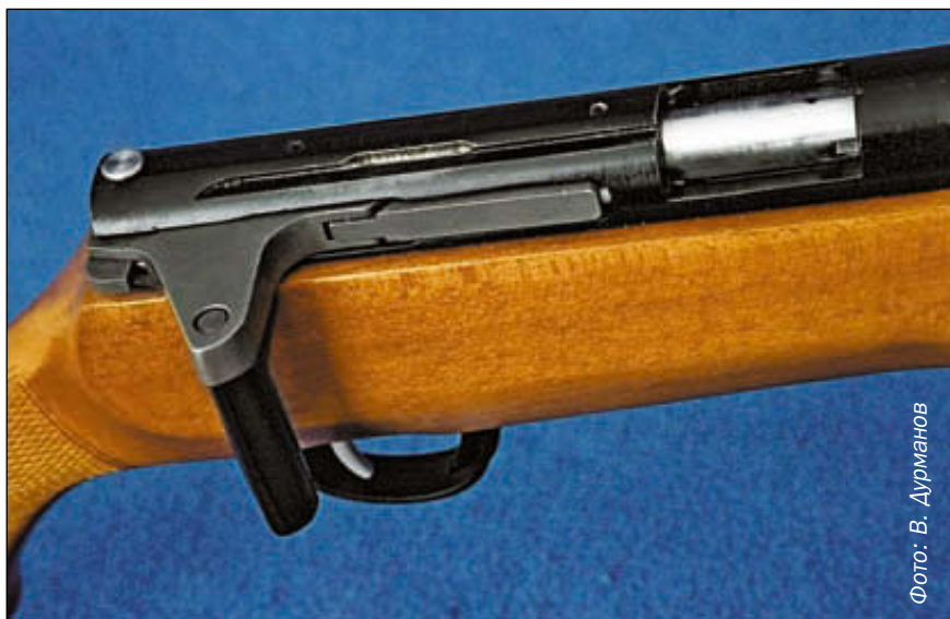
Доработанная автором статьи планка для крепления кронштейна оптики
