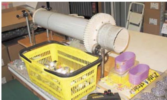
Сепаратор, на котором от пулек отделяется облой
