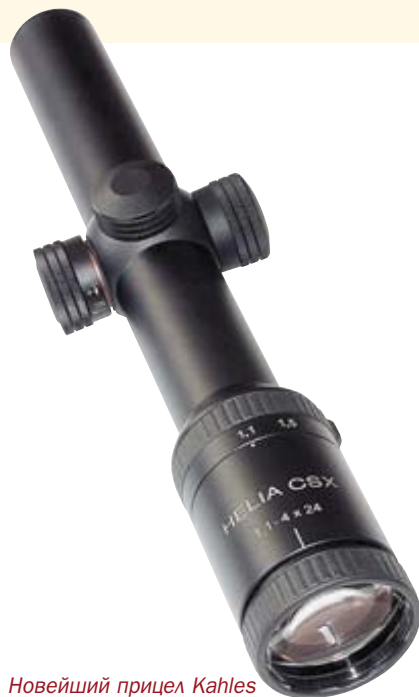
Новейший прицел Kahles CSX 1.1-4x24. Для включения подсветки необходимо оттянуть кольцо регулятора (на иллюстрации слева)
