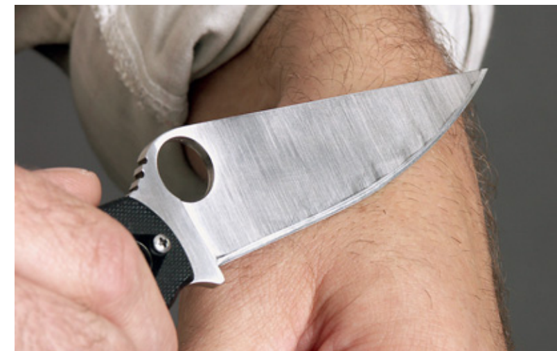
Совершенно ненаучный и небезопасный способ проверки остроты лезвия и качества заточки – это проба бритья волос на предплечье или верхней стороне ладони. Бреет или нет, и если бреет, то насколько легко
