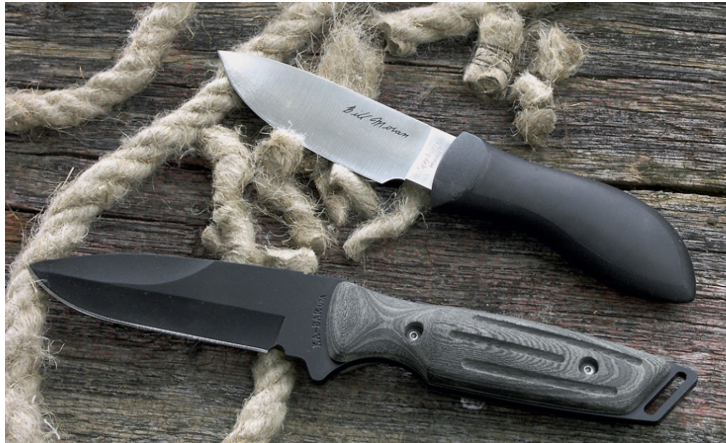
То, что лезвие бреет волосы на руке, ещё не до конца положительно свидетельствует о его реальных режущих свойствах, и вот достаточно характерный пример. Плоско спущенный к тонкому лезвию 10-сантиметровый клинок верхнего ножа легко и чисто перерезает полудюймовую пеньковую веревку в один проход, даже не всей длиной лезвия. Более круто спущенный к более толстому лезвию клинок нижнего ножа, хотя и несколько более длинный, только надрезает веревку до половины её толщины при первом проходе. Чтобы перерезать полностью, рез необходимо повторить, да и то получается он не слишком чистый, растрепанный. С помидорами разница окажется еще более заметной
