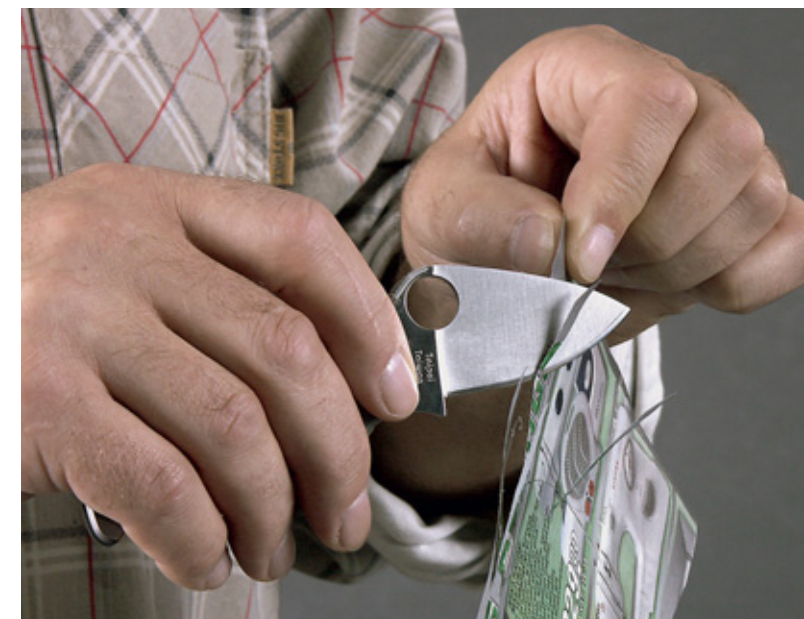
Очень остро и, следовательно, тонко заточенный нож строгаёт удерживаемый на весу лист тонкой бумаги в тоненькую «лапшу» даже без всякого потяга
