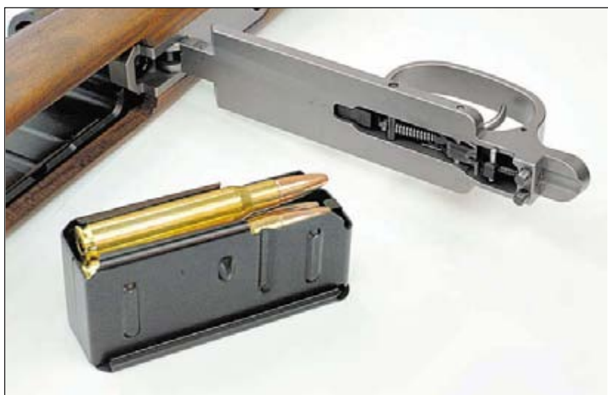
Извлечение магазина возможно только при открытой крышке – основании спускового механизма
