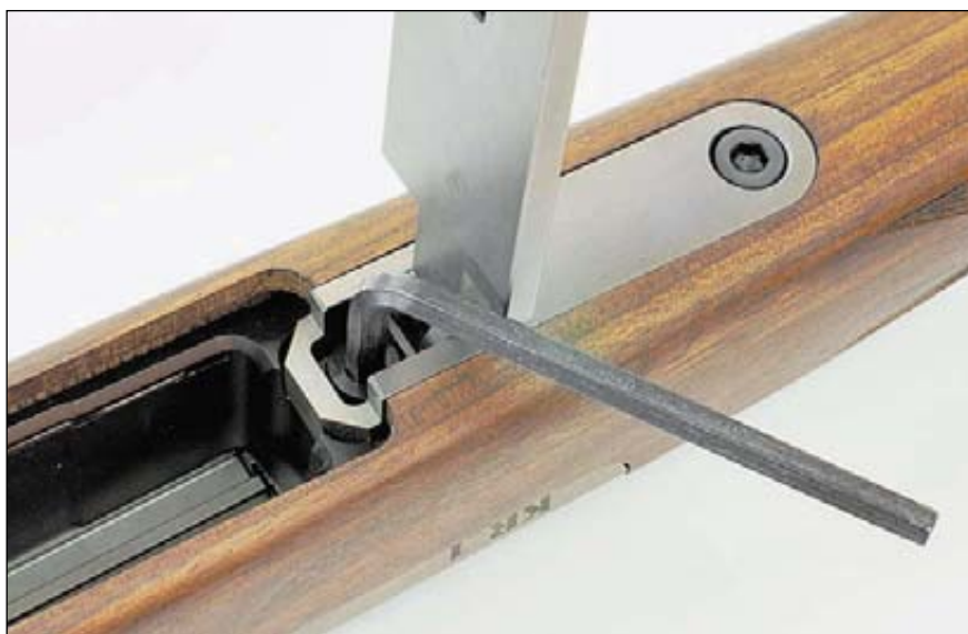
Для отсоединения ствола необходим ключ. Вся процедура замены ствола занимает не больше пяти минут
