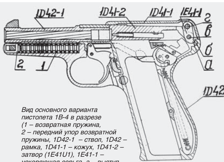
Общий вид основного варианта пистолета 1В4
