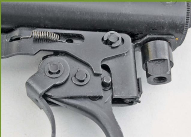
У Quest 1000 резьбовая втулка прижимает к цилиндру хвостовик, составляющий с корпусом спускового механизма единое целое. На этой же фотографии видно, что пружина автоматического предохранителя располагается снаружи...
