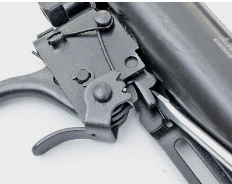
Кратковременное крайнее заднее положение шептала пришлось воспроизводить с помощью отвёртки. Обратите внимание на взаимное расположение самого шептала и его рычага
