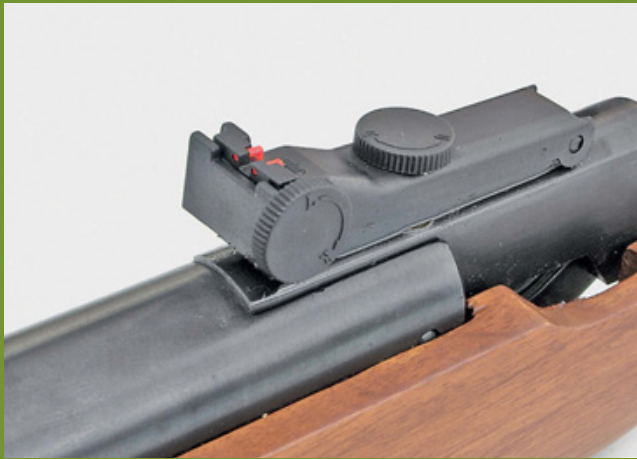
Открытый прицел с красными вставками регулируется по двум осям. Примечательно, что у испанских винтовок (не только у «гамовских», но и у «норик» с «кометами») цветовая комбинация противоположная
