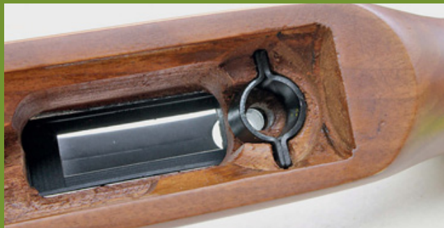
Обойма в ложе для промежуточной втулки крепления воздушного цилиндра в Quest 1000...
