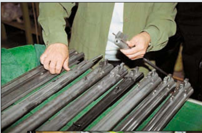
Мастерская Вольфа на стороне покупает только заготовки стволов. Всё остальное делается собственными силами
