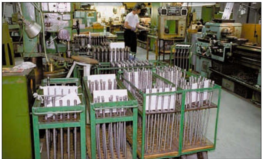
Ствольное производство «Меркеля» полностью обеспечивают собственные потребности завода. Мощности позволяют поставлять нарезные и гладкие кованые стволы другим оружейным фабрикам
