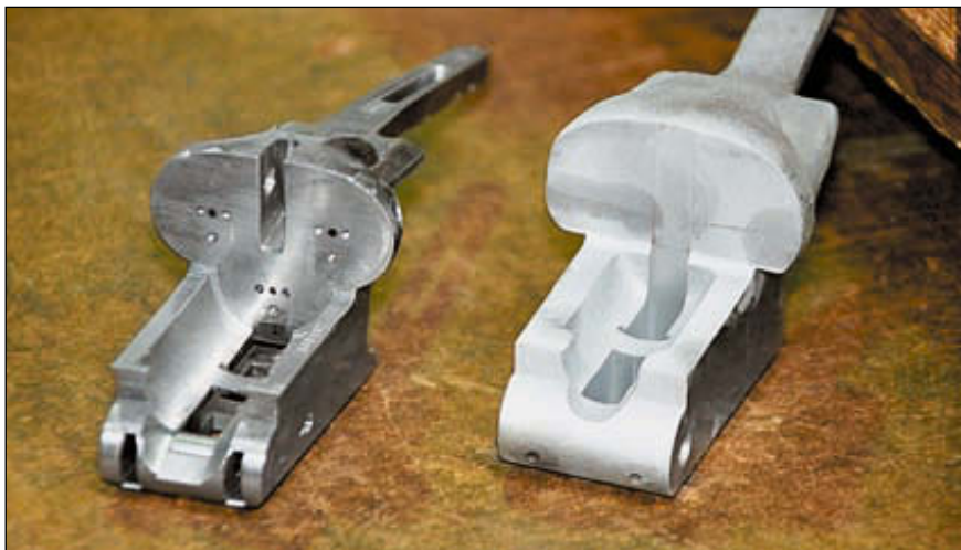
Обработка заготовок колодок, закупаемых на стороне (справа), производится на современных обрабатывающих центрах с компьютерным управлением, которые обеспечивают высочайшую точность размеров готовой детали
