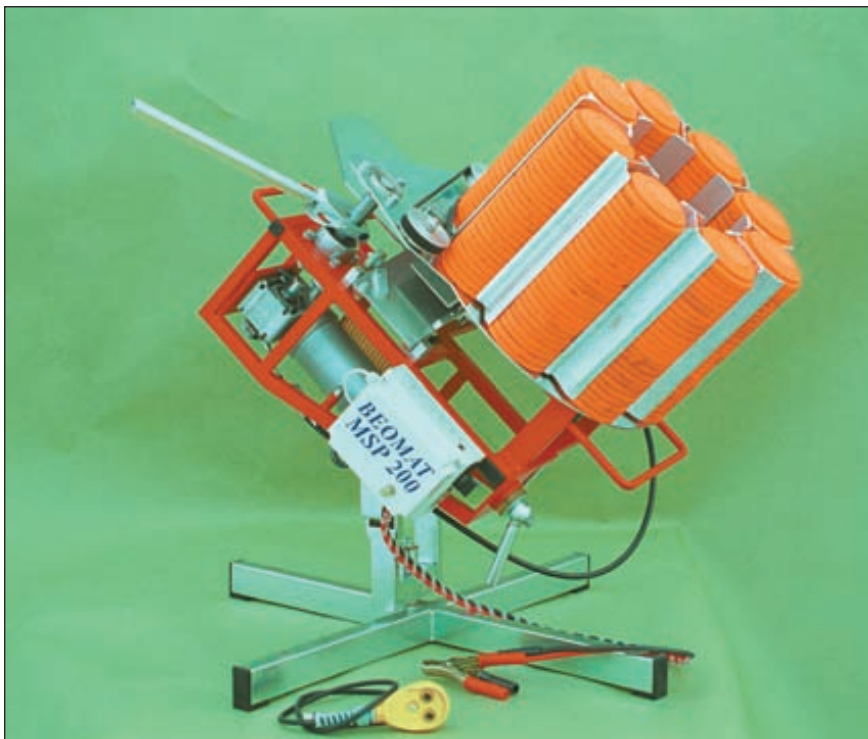
Переносная метательная машинка BEOMAT MSP 200. Конструкция достаточно универсальна и обладает широким диапазоном регулировок, обеспечивая запуск мишеней по самым разнообразным траекториям. Машинка широко используется на площадках для спортивного стрельба
