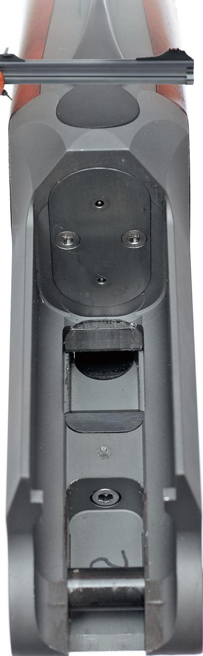
Вид на ствольную коробку изнутри. «Зеркало» коробки защищено стальной пластиной
