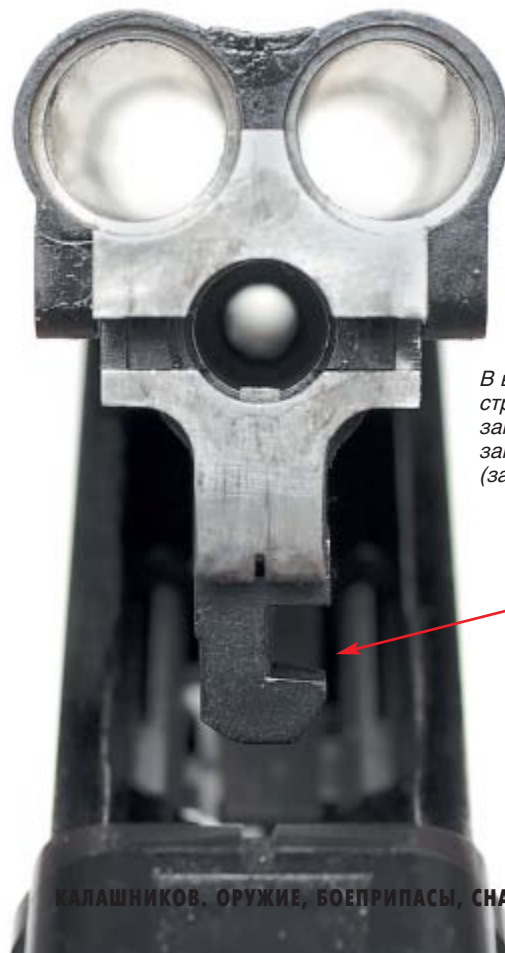
Переводчик ударного механизма перемещается вверх – вниз и имеет два положения маркированных литерами «Н» (нижний ствол) и «В» (верхний ствол)
