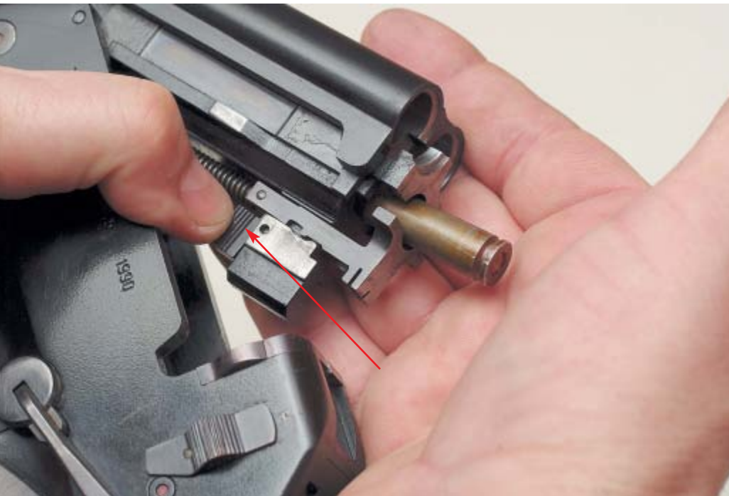
Выбрасывание гильзы 5,45-мм патрона происходит при нажатии на кнопку эжектора (указана стрелкой)
