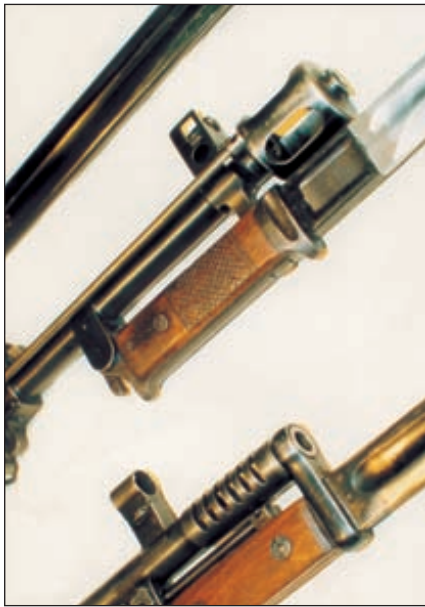
Клиновые штыки на винтовках АВС-36 (вверху) и СВТ-40: хорошо видны различия в конструкции крепления штыка к винтовке
