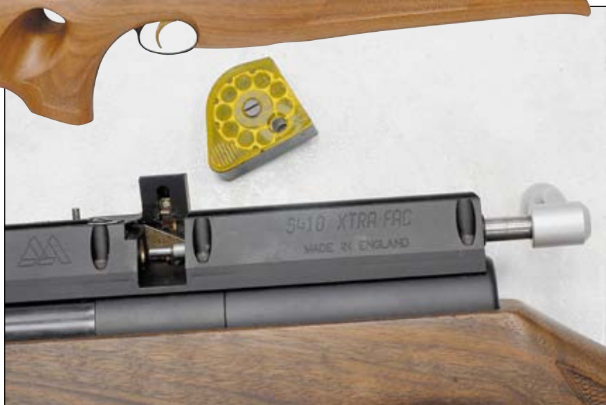
Пневматическая винтовка Air Arms S410 Carbine с присоединённым модератором. Калибр 5,5 мм. Примерная цена $ 1320 10-зарядный барабан винтовки Air Arms S410 заключён в своеобразный пластиковый кожух
