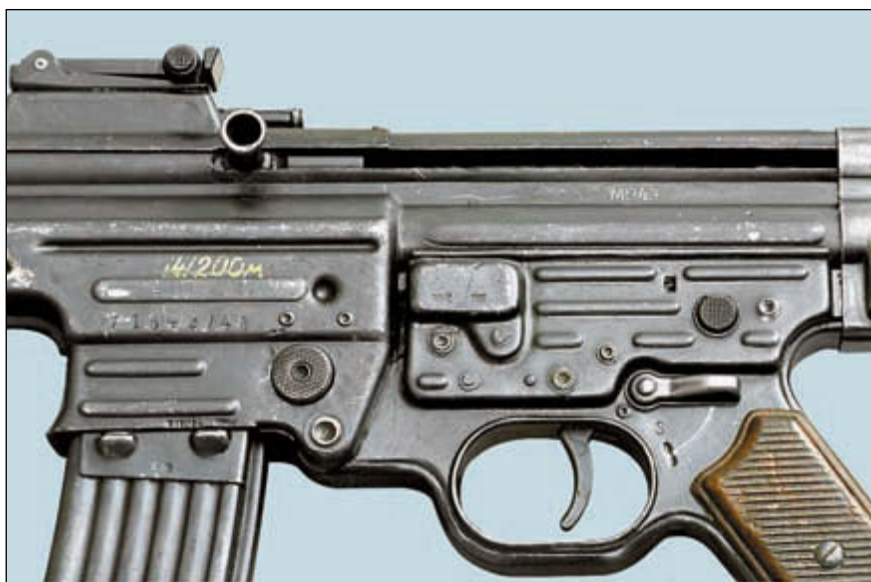
Автомат MP 43 системы Х. Шмайссера. Переработан из образца Mkb 42(H) с учётом результатов сравнительных войсковых испытаний зимой 1943 г., проводившихся одновременно и с автоматом Mkb.42(W) фирмы Walther. Ход газового поршня переделан с длинного на короткий, укорочена трубка газовой камеры, ударно-спусковой механизм ударникового типа переделан на более надёжный курковый, введён флажковый предохранитель
