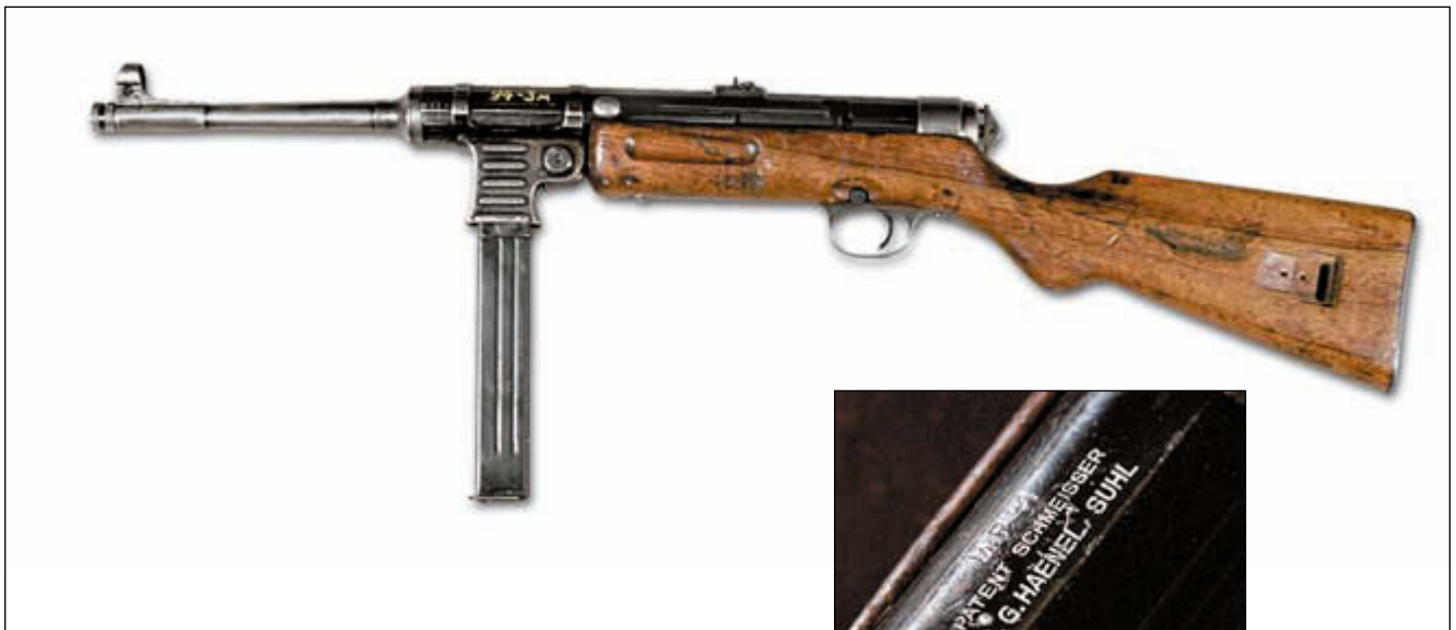
VI. Немецкий пистолет-пулемёт MP 41 системы Х. Шмайссера Представляет собой комбинацию узлов и деталей пистолетов-пулемётов MP 28.II (ложа и спусковой механизм) и MP 40 (ствол с затворной коробкой, затвор и возвратно-боевая пружина). В общей сложности было изготовлено 27600 штук. Принцип автоматики – свободный затвор. Калибр 9 мм Парабеллум. Общая длина 860 мм. Длина ствола 250 мм. Масса без патронов 3870 г. Масса с патронами 4540 г. Темп стрельбы 500 выстр./мин. Начальная скорость пули 380 м/сек. Эффективная дальность стрельбы 200 м. Емкость магазина 32 патрона.
