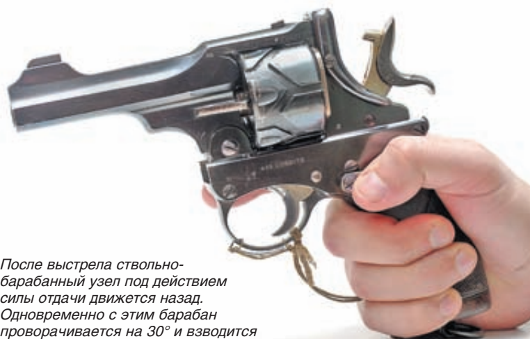
В момент накола капсюля патрона ствольно-барабанный узел револьвера находится в крайнем переднем положении
