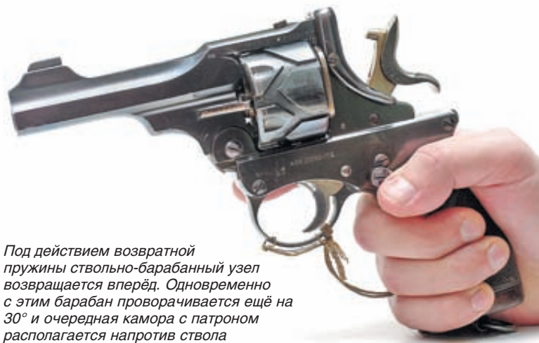
После выстрела ствольно-барабанный узел под действием силы отдачи движется назад. Одновременно с этим барабан проворачивается на 30° и взводится курок
