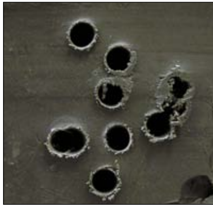
Вот такие отметины в пластилиновом блоке оставили пули, выпущенные из 5,5-мм РСР-винтовки (масштаб 1:1)
