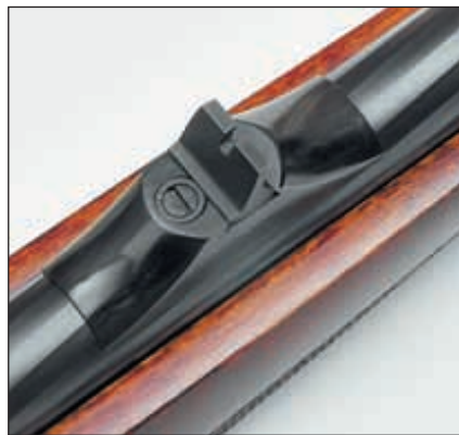
Регулируемый по горизонтали целик фиксируется специальным винтом.
