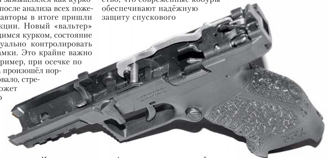
Как говорят немцы, фотоснимок «внутренней жизни» пистолета. Хорошо видно, что внутри пластиковой рамки находится металлический вкладыш с деталями ударно-спускового механизма. Фото автора.
