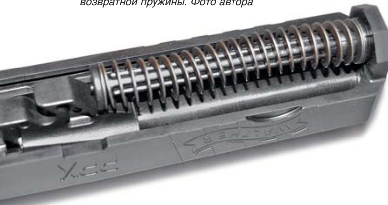
Возвратный механизм. Фигурный прилив в нижней части ствола служит опорой для заднего конца возвратной пружины. Фото автора
