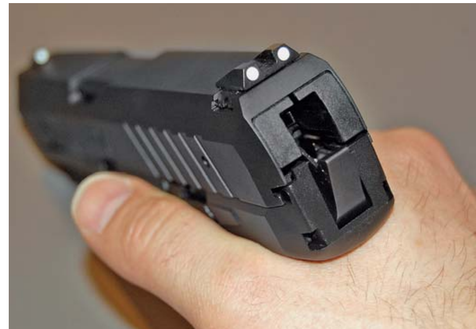
В обычном состоянии курок утоплен в рамке, он выходит за её пределы только в процессе выстрела. Фото автора
