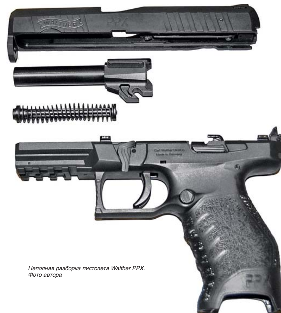
В обычном состоянии курок утоплен в рамке, он выходит за её пределы только в процессе выстрела. Фото автора
