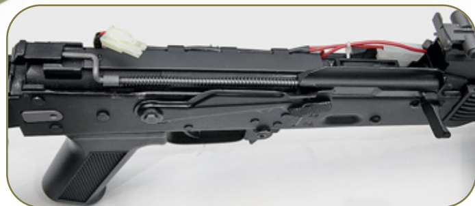
ИЖ-124 – первый российский airsoft-«калашников» с электроприводом. При снятой крышке ствольной коробки виден разъем аккумуляторов, которые в автомате располагаются поверх компрессора
