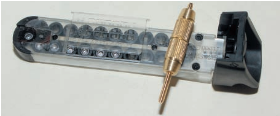
Магазин «Беркута» с приоткрытой крышкой. Лежащий сверху досыпатель – весьма полезная вещь для «эйрганера»
