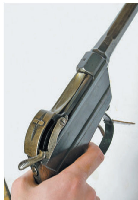
Для перезаряжания пистолета Вердера стрелок должен нажать на «зеркальный спусковой крючок» (1) после чего открывается затвор (2). Выемка на верхней части затвора облегчает досылание патрона в патронник. После этого отпускаем рычаг открывания затвора и взводим курок. При взведении курка одновременно происходит и запираение затвора. Пистолет готов к стрельбе
