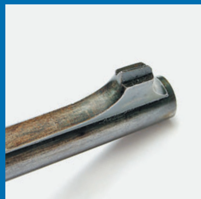
Прицельное приспособление пистолета состоит из целика и мушки. Мушка вместе с основанием выполнена единой цельной деталью и припаяна (или приварена) к стволу, а целик является частью корпуса УСМ. Ни о какой пристрелке без напильника не могло быть и речи
