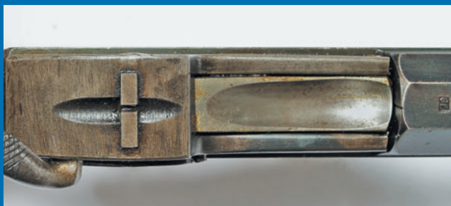
Прицельное приспособление пистолета состоит из целика и мушки. Мушка вместе с основанием выполнена единой цельной деталью и припаяна (или приварена) к стволу, а целик является частью корпуса УСМ. Ни о какой пристрелке без напильника не могло быть и речи
