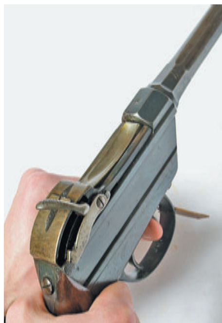
Для перезаряжания пистолета Вердера стрелок должен нажать на «зеркальный спусковой крючок» (1) после чего открывается затвор (2). Выемка на верхней части затвора облегчает досылание патрона в патронник. После этого отпускаем рычаг открывания затвора и взводим курок. При взведении курка одновременно происходит и запираение затвора. Пистолет готов к стрельбе
