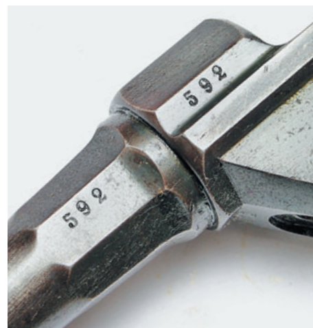
Серийный номер пистолета проставлялся на всех элементах конструкции – деталях УСМ, стволе и ствольной коробке.
