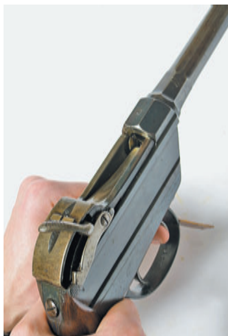
Для перезаряжания пистолета Вердера стрелок должен нажать на «зеркальный спусковой крючок» (1) после чего открывается затвор (2). Выемка на верхней части затвора облегчает досылание патрона в патронник. После этого отпускаем рычаг открывания затвора и взводим курок. При взведении курка одновременно происходит и запираение затвора. Пистолет готов к стрельбе
