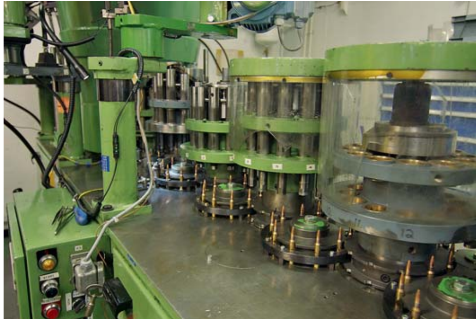
На роторной линии по сборке патрона .30-06 Spr. по частоте манипуляций пневмозахвата я смог оценить производительность оборудования – около 100 патронов в минуту
