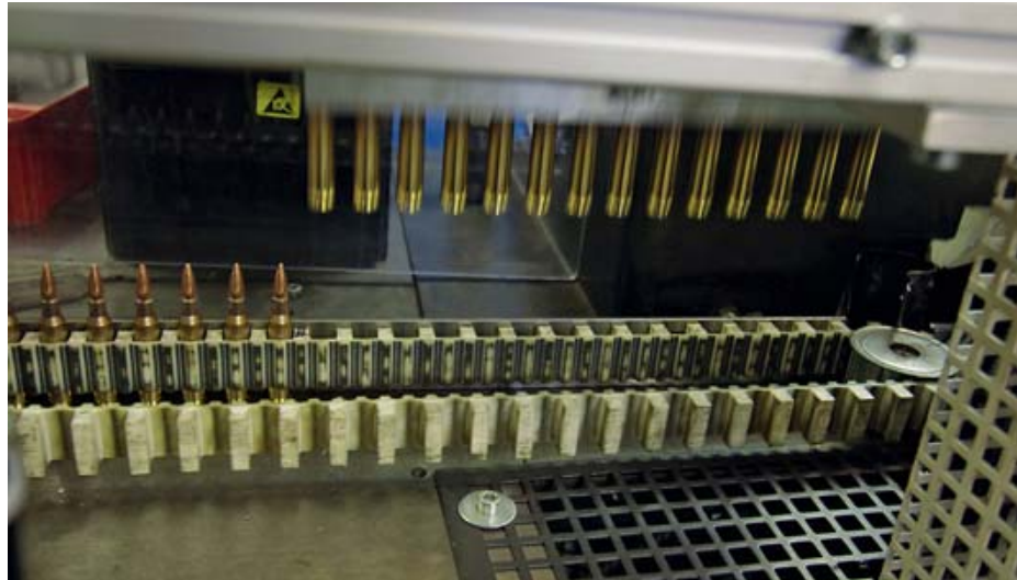
На роторной линии по сборке патрона .30-06 Spr. по частоте манипуляций пневмозахвата я смог оценить производительность оборудования – около 100 патронов в минуту
