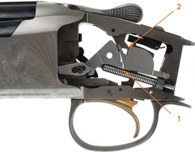
Курки взведены, боевые пружины сжаты, передние концы их толкателей приопущены. «П»-образная рамка своей поперечной почти касается витков боевых пружин (1). Предохранитель выключен, центральный рабочий зуб спусковой тяги находится под задним выступом правого шептала (2). Всё готово для выстрела из нижнего ствола (правый ударный механизм).
