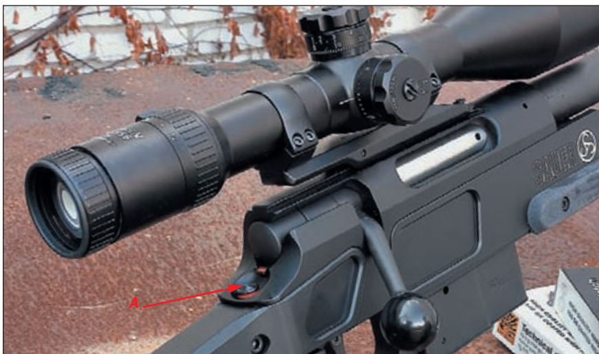
При нажатии на кнопку (указана стрелкой) предохранитель включается. При взведённом ударнике виден его хвостовик, окрашенный в красный цвет, позволяющий оценить состояние УСМ визуально и наощупь. Дистанционный барабан прицела
