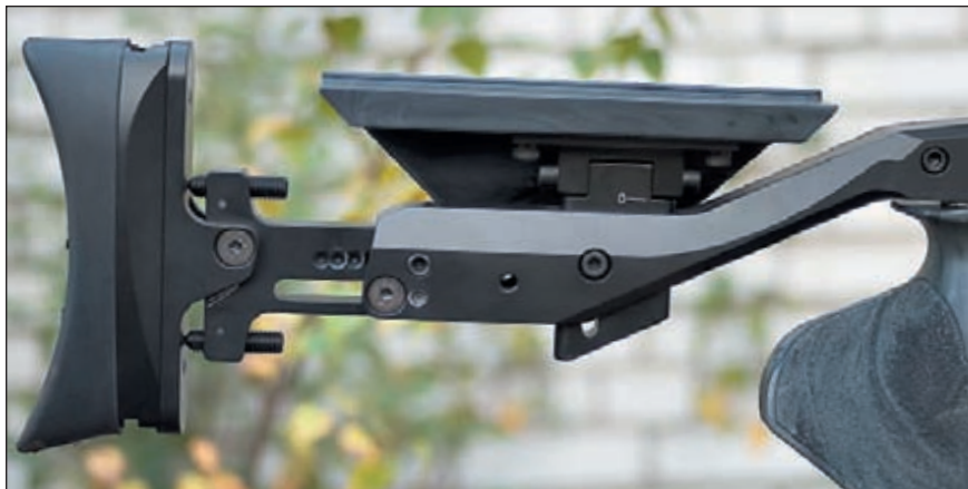
Затыльник приклада, подщёчник и рукоятка в сумме имеют 8 регулировок
