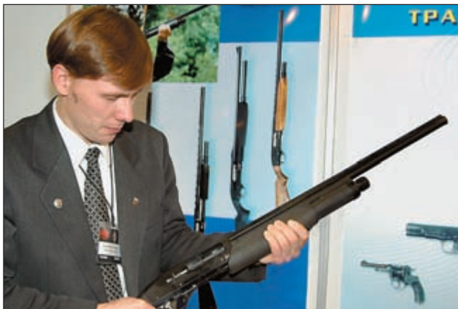
Ижевское ружьё MP-154 может работать в двух режимах: ручная перезарядка подвижным цевьем и автоматическое перезаряжание, подобно MP-153 с газовым двигателем
