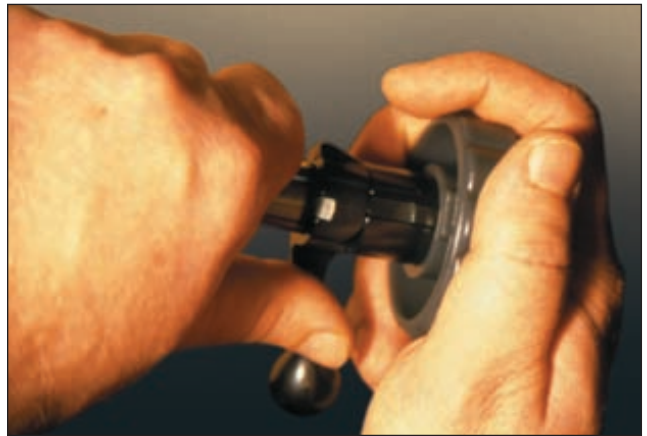
Для упрощения разборки-сборки затвора в комплект карабина входит специальный ключ
