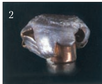
Различные типы после попадания в тело животного: 1 - Super Hammerhead; 2 - Hammerhead; 3 - Twinhead; 4 - Powerhead
