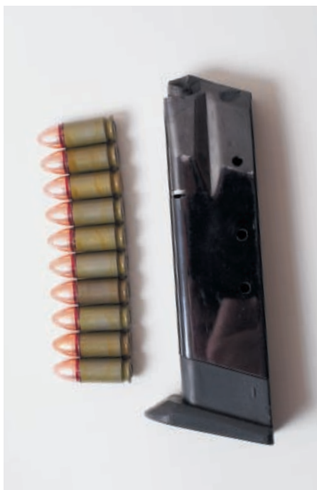
Конструкция пистолета позволяет использовать магазины вместимостью 10 и 17 патронов
