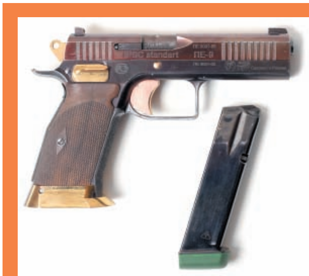
Общий вид пистолета ПЕ-9 под патрон 9x19. При взведённом курке пистолет можно поставить на предохранитель, что при наличии патрона в патроннике даёт возможность стрелку быстро произвести первый выстрел, для чего достаточно снять пистолет с предохранителя и нажать на спусковой крючок
