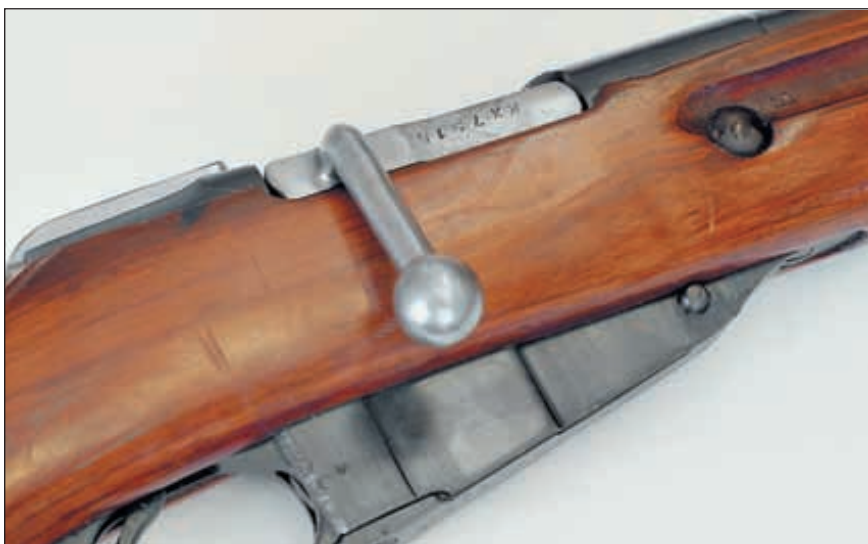
Рукоятка затвора снайперской винтовки изогнута для обеспечения перезарядки при установленном оптическом прицеле, зарядание из обоймы при этом невозможно
