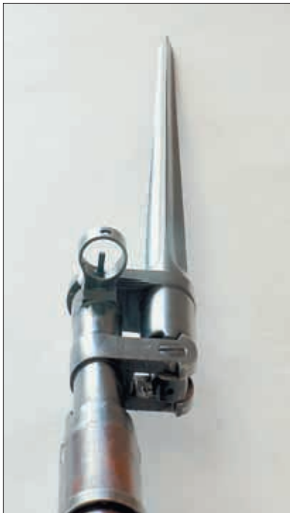
Штык имеет отвод вправо для исключения влияния на угол вылета пули, так как опытные карабины обр. 1943 г. не имевшие отвода штыка давали отклонение пули влево на 50 см для дальности 100 м по сравнению с боем при установке штыка в походное положение
