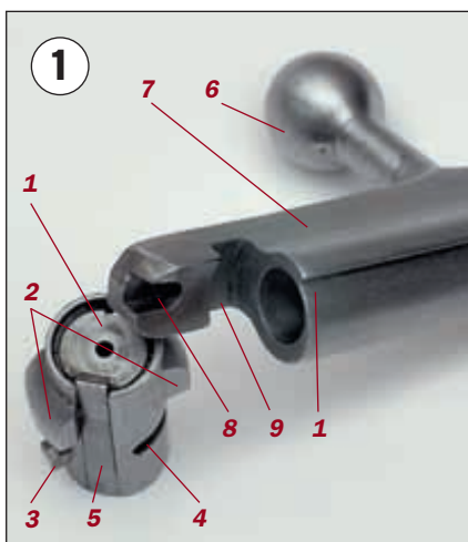
Затвор винтовки состоит из боевой личинки с выбрасывателем (1), стебля (2), курка (3), ударника (4) и боевой пружины (5), фиксируемых между собой соединительной планкой (6)
