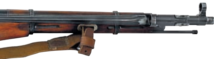
7,62-мм карабин обр. 1944 г., вид справа, откидной штык в походном положении (сложен)
