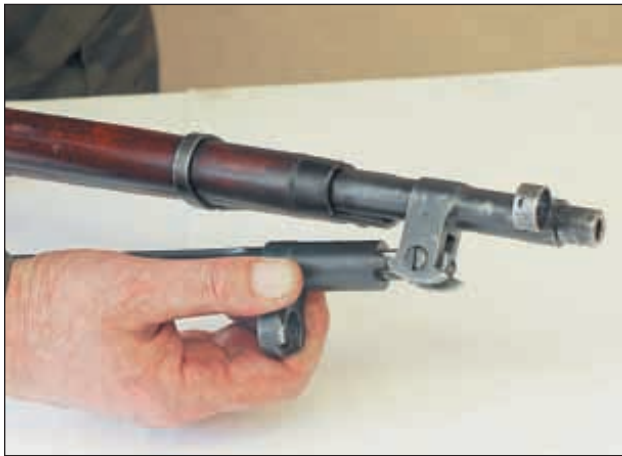
Перевод штыка карабина обр. 1944 г. Из походного положения в боевое: оттянуть штыковую трубку на себя и резко откинуть штык вперед налево до четкой фиксации
