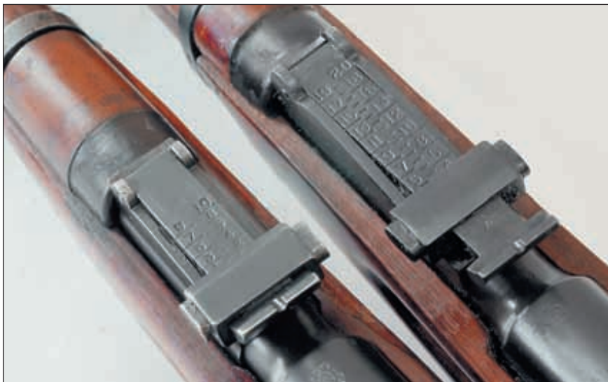
Прицельные планки карабина (слева) и винтовки
