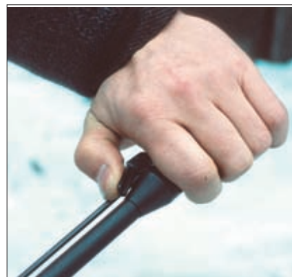
Предохранитель винтовки MP-513M позволяет с одинаковым удобством как визуально, так и на ощупь определить его состояние. При взведении поршня предохранитель включается автоматически
