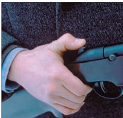
Предохранитель винтовки MP-513M позволяет с одинаковым удобством как визуально, так и на ощупь определить его состояние. При взведении поршня предохранитель включается автоматически
