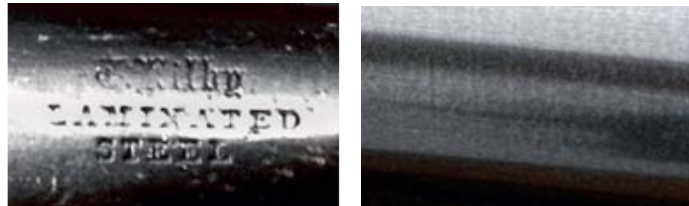
Ламинированная английская сталь: так она выглядела в 1858 г. (вверху), клеимо на стволах, изготовленных из ламинированной стали Томасом Килби (слева), 3-полосная сталь конца XIX в. (справа)
