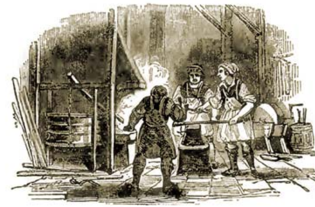
Рисунки из книги Вильяма Гринера (старшего) «Оружейное дело в 1858 г.» Заварка стволов (слева), сверловка стволов (справа).
