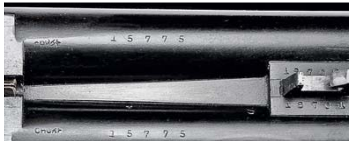
Ствольный блок ружья Пёрдэ №15775 (1897 г.), надпись на прицельной планке J. Purdey & Sons. Audley House, South Audley Street, London. Made of Sir Joseph Whitworth's Fluid Compressed Steel, стволы №18700/18701, клейма «стоящий сноп» нет
