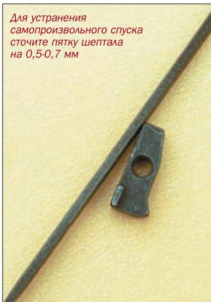
*Для устранения самопроизвольного спуска сточите пятку шептала на 0,5-0,7 мм*
