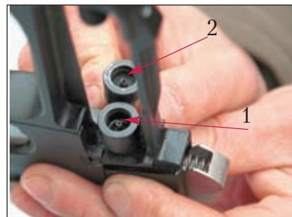
*В клапанном устройстве 1 видна неправильная заточка иглы. В номере 2 игла заточена правильно, удалено большое уплотнительное кольцо и установлена самодельная нижняя прокладка*
