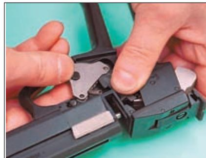
Установка спускового механизма на место
