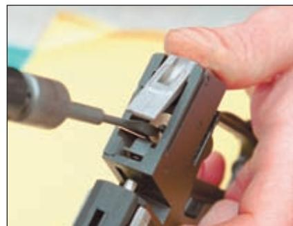
*Если клапанное устройство застряло в корпусе, необходимо снять прицельную колодку и выбить устройство сверху*
