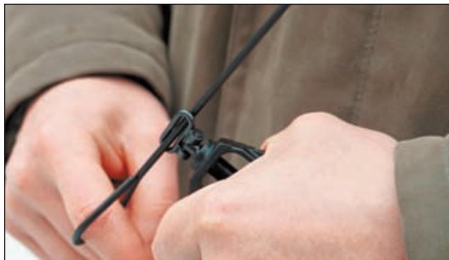
*При помощи шомпола, с приобретением навыка можно довольно быстро затянуть баллончик при снятом верхнем уплотнительном кольце клапанного устройства*
