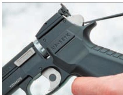
*Перед удалением балончика обязательно стравите газ при помощи шомпола или отвёртки*
