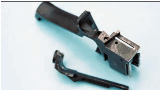
*Причиной излома корпуса могут являться раковины в структуре металла или излишнее усилие при затягивании баллончика*
