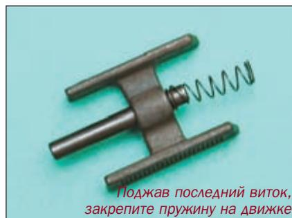
Поджав последний виток, закрепите пружину на движке
