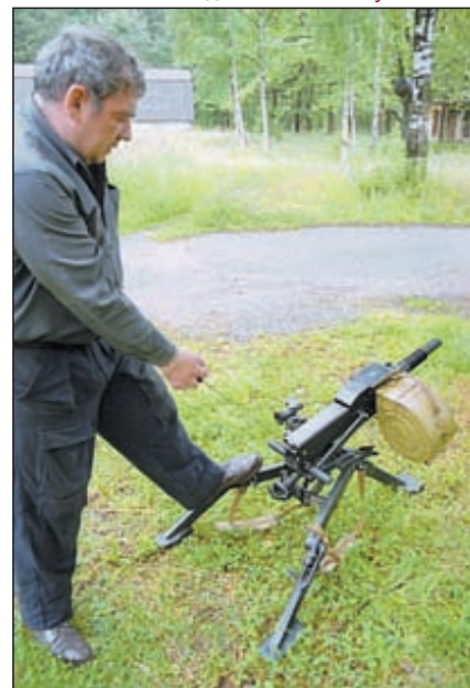
Для зарядания гранатомета необходимо отвести затвор за рукоятку до отказа и отпустить её
