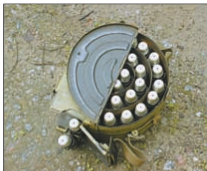
Патронная коробка с уложенной лентой. Патронная лента состоит из трёх кусков, по десять звеньев в каждом. Куски соединяются друг с другом гранатой
