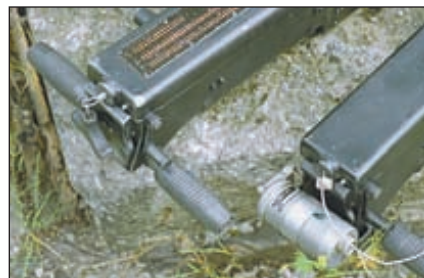
Управление огнём авиационного гранатомёта, используемого, в основном, на вертолётках, осуществляется с помощью электроспуска (справа)
