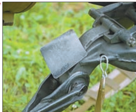
Отражатель стреляных гильз на станке препятствует застреванию гильз между коробом и станком при низких углах возвышения ствола
