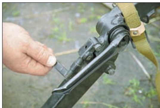
Для горизонтирования станка предназначен специальный механизм на правой ноге станка
