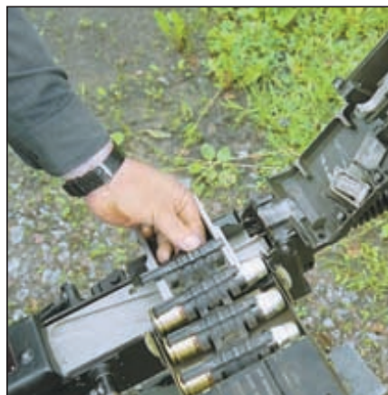
Перед заряданием гранатомёта первое пустое звено ленты укладывается в лоток открытого приёмника. Именно из-за этой особенности в ленту помещается 29 выстрелов, а не 30, по количеству звеньев
