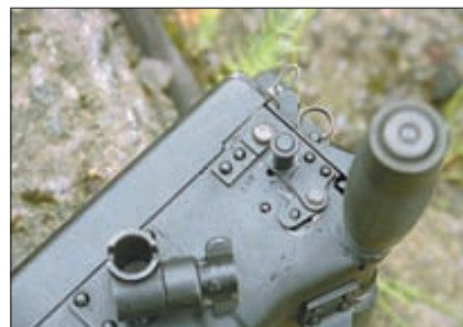
Переводчик режимов огня расположен с левой стороны короба рядом с рукояткой управления огнём
