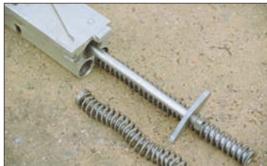
Возвратные пружины и шток гидравлического тормоза
