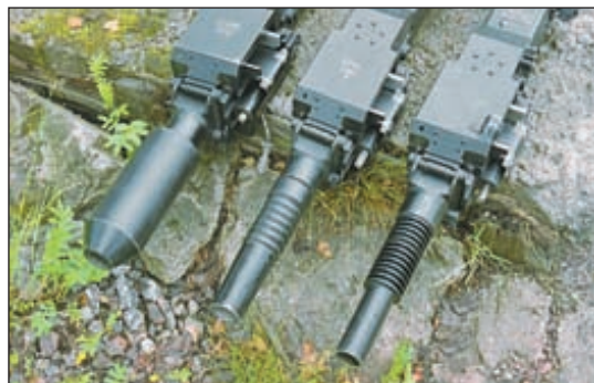
Ствол авиационных гранатомётов (слева) для лучшего охлаждения оснащается массивным алюминиевым насадком.
