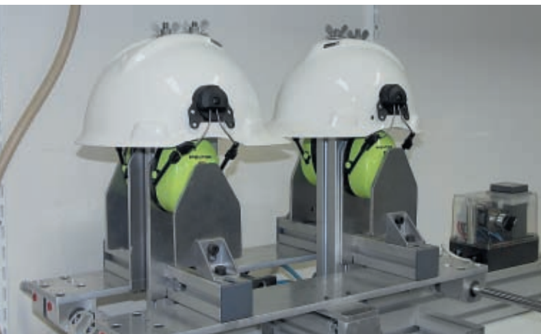
Испытание оголовья на механическую прочность
