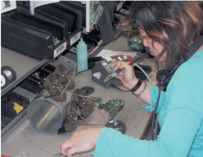
Сборка электронных компонентов наушников ComTac
