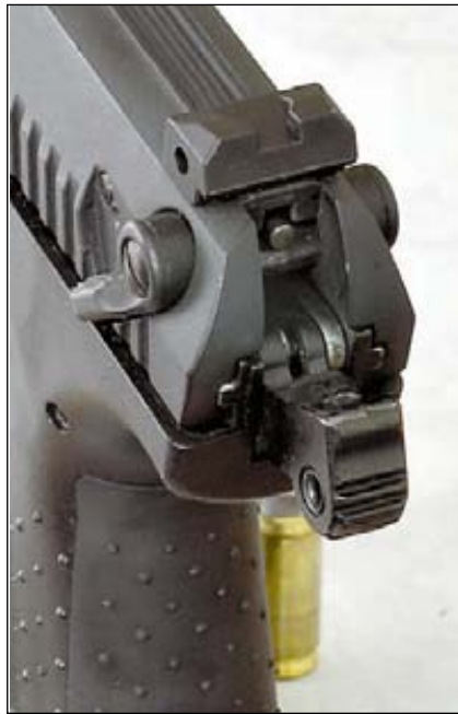
Во включенном положении (слева) предохранитель препятствует удару курка по ударнику, например, при падении пистолета на курок со спущенным курком
