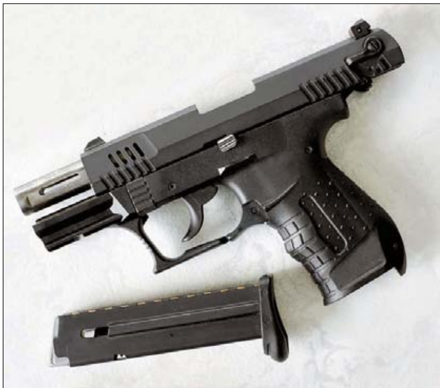
Walther P22T оснащается автоматической затворной задержкой, которая включается после израсходования патронов в магазине
