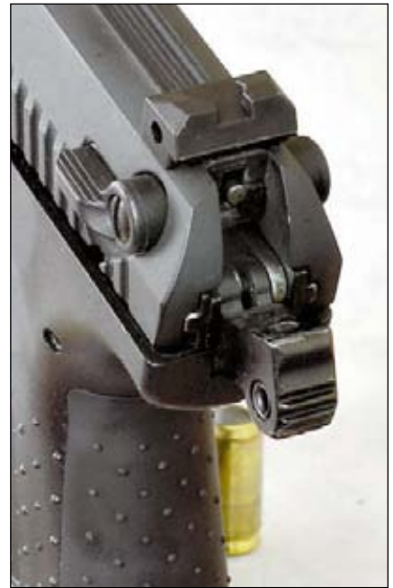
Во включенном положении (слева) предохранитель препятствует удару курка по ударнику, например, при падении пистолета на курок со спущенным курком
