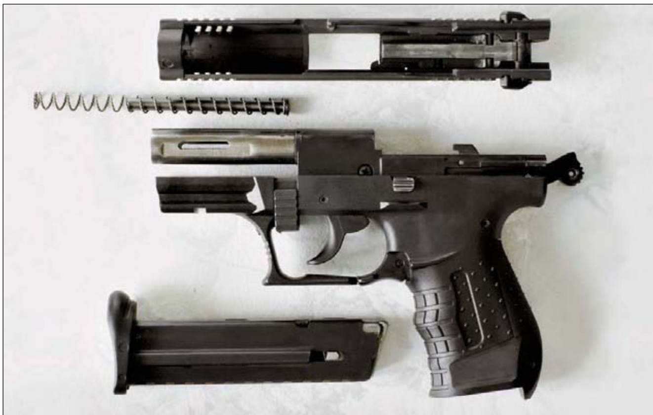
Детали неполной разборки пистолета Walther P22T. Обратите внимание на характерный фальшствол большого диаметра с боковыми прорезями
