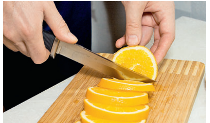
Из-за толщины клинка и особенностей его заточки режущие свойства ножа Cold Steel SRK (слева) несколько хуже, чем у ножа SOG Tsunami, но они достаточно приличные. Про Tsunami же можно сказать, что он действительно «режет как по маслу»
