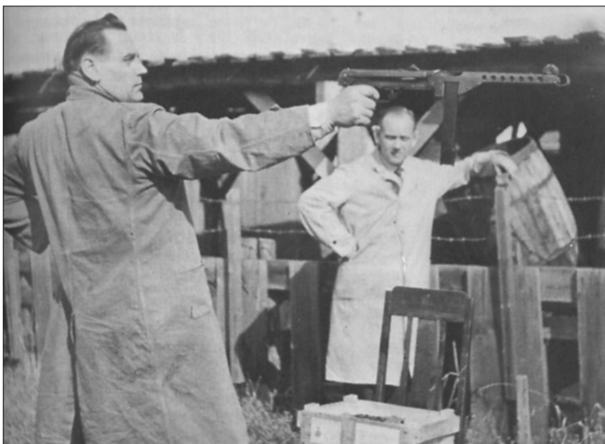
Финский пистолет-пулемёт m/44 с финским магазином m/55 вместимостью 36 патронов, который был разработан после войны
