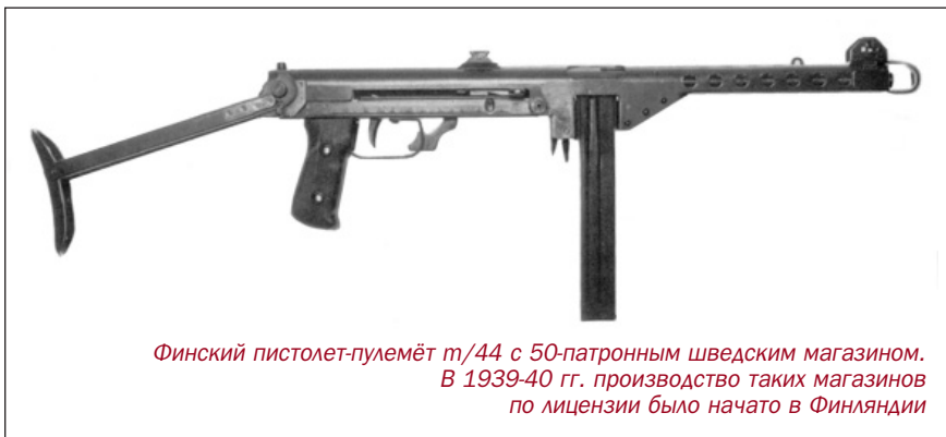
Прототип финского пистолета-пулемёта m/44. Данный образец представляет собой советский ППС-42, переделанный под патрон 9x19 Para
