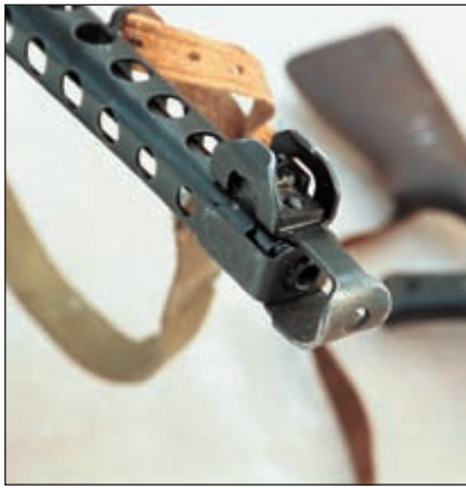
Дульный тормоз-компенсатор ППС-43. Мушка ПП по вертикали регулируется её ввинчиванием или вывинчиванием, а по горизонтали перемещением её основания с помощью выколотки
