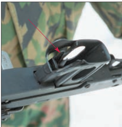
Во избежание случайного нажатия защёлка магазина (а) размещена в гнезде приёмника
