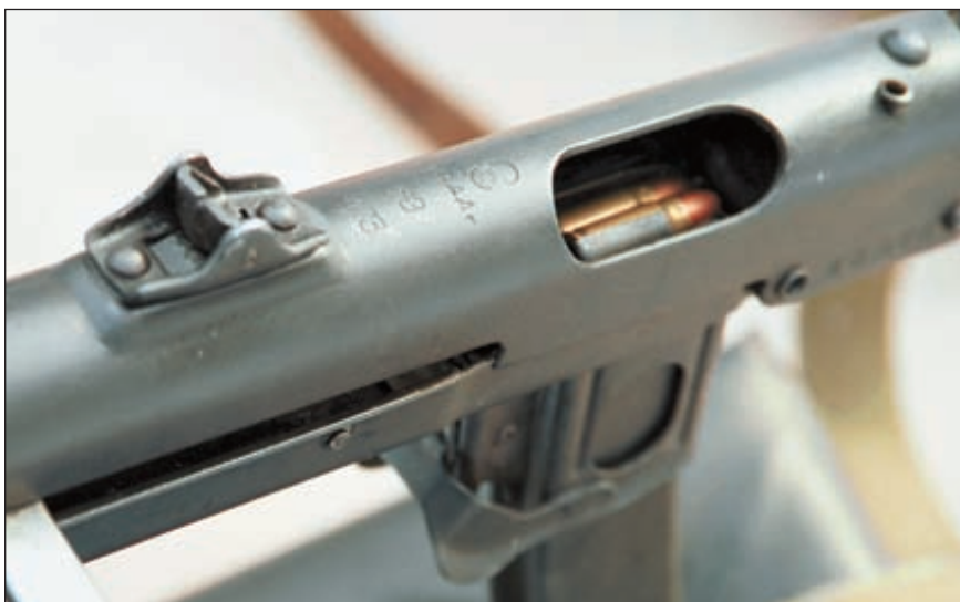
Для улучшения условий охлаждения ствола кожух не замкнут с нижней части. Стрелкой показана ось фиксирующая ствол
