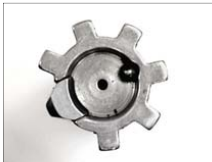
Вид спереди на затвор. Хорошо видны шесть боевых упоров
