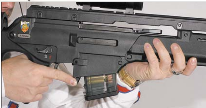
При нажатии на защёлку магазин свободно выпадает из приёмника
