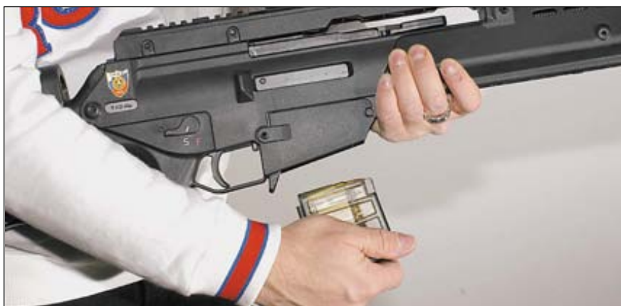
Присоединение магазина упрощается за счёт широкой горловины приёмника
