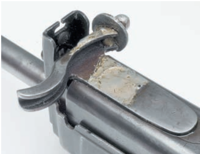
Двусторонняя рукоятка взведения затвора когда-то была симметричной. Во время проведения испытаний на полигоне для определения скоростей подвижных деталей её правая часть была приспособлена для размещения датчика. Хорошо видна характерная форма прорези целика
