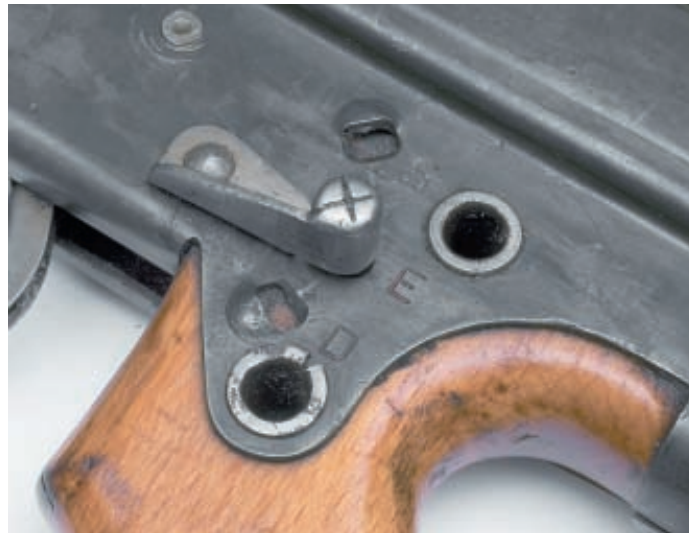
Переводчик огня одновременно служит предохранителем
