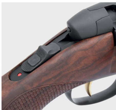
При перемещении ползуна в переднее положение (видна красная марка – положение «Огонь») ударник ставится на боевой взвод, о чём свидетельствует выступающий из затыльника затвора хвостовик. При последующих манипуляциях с перезаряданием оружия при активированном взводителе ударник взводится аналогично «нормальной» системе с поворотным затвором
