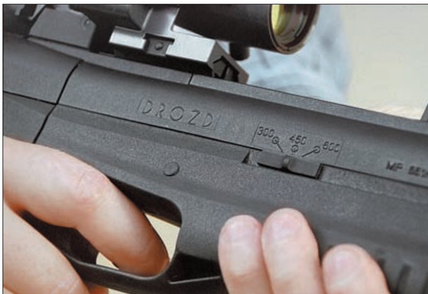
На правой стороне корпуса автомата находится трёхпозиционный (300, 450 и 800 выстр./мин.) переключатель темпа стрельбы
