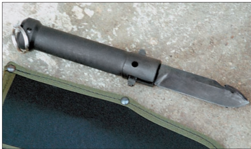
«Стреляющий» нож конструкции Игоря Скрылёва представил сам разработчик. Отстрел лезвия возможен только при извлечённой чеке в тыльной части рукоятки
