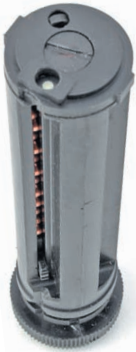
Общий вид блока магазинов. Обратите внимание на положение верхней поворотной крышки: в её загрузочном отверстии видна белая метка. Именно при таком положении крышки блок вставляется в рукоятку пистолета
