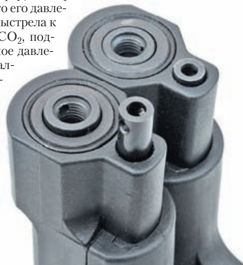
При постановке ствола на боевой взвод он выдвигается на 11 мм
