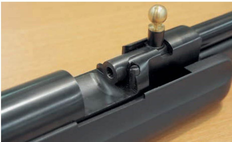
Так выглядит узел запирания у винтовки Hatsan Torpedo 150 TH. Ствол в крайнем переднем положении, пространство между его казённым срезом и воздушным цилиндром позволяет работать с любыми пулями
