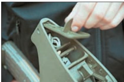
*Принадлежность укладывается в специальное гнездо под затыльником приклада*
