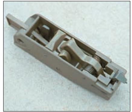
*Ударно-спусковой механизм практически полностью изготовлен из полимерных материалов*
