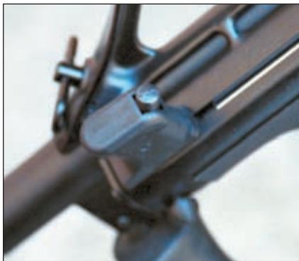
*На некоторых модификациях рукоятка перезарядки оснащается фиксатором, позволяющим с помощью рукоятки докрывать затвор*
