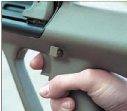
*Рукоятка перезаряжания в крайнем заднем положении фиксируется*
