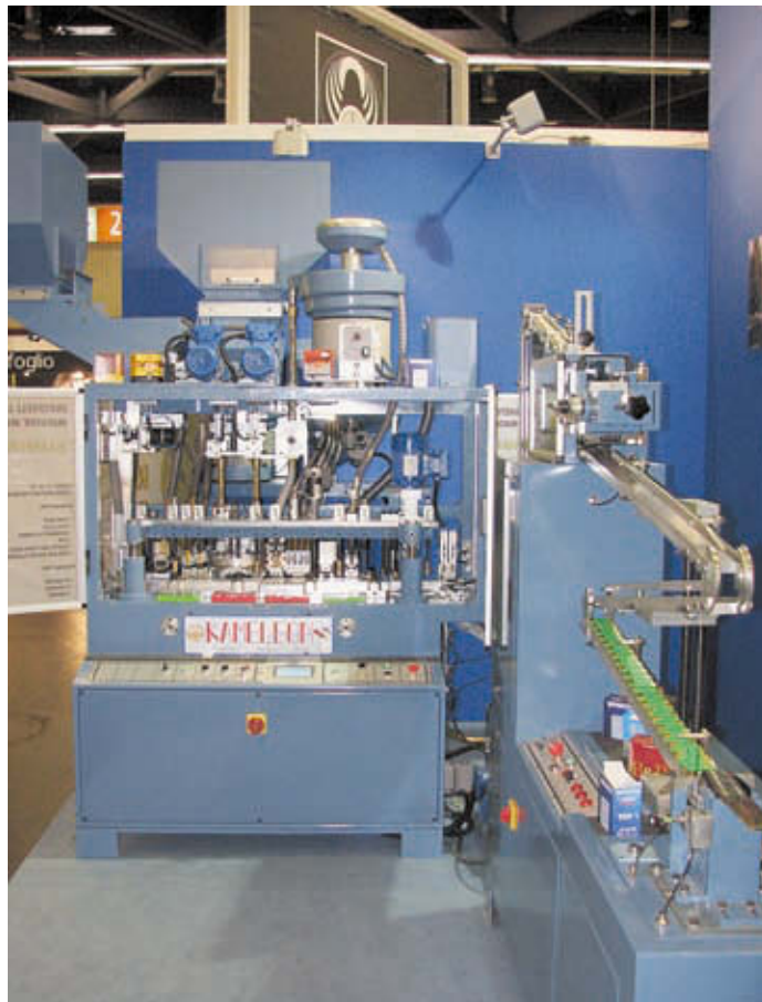
Так компактно выглядит новая линия по изготовлению патронов для гладкоствольного оружия итальянской компании B.S.N. Technology
